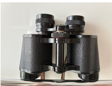
Fig. 5: Prismáticos “porro”. Figs. 6 y 7: prismáticos “techo”.
