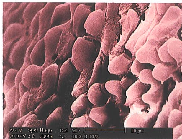
FIG. 15.—Aspecto de la superficie de los gránulos de hidroxiapatita sinterizados en la fabricación de una prótesis de reconstrucción ósea (Microscopia electrónica de barrido \times 2,000 .)
