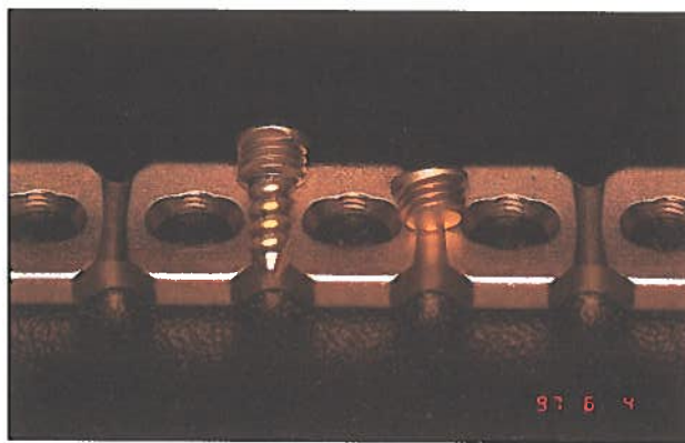
FIG. 7.—Placa de reconstrucción mandibular del sistema Unilock con el tornillo y botón. Los agujeros poseen una rosca interior para la adaptación de la porción roscada de la cabeza del tornillo. La misión de los botones es prevenir la deformación de los orificios de la placa durante su doblado que pudiese interferir posteriormente con la inserción de los tornillos.
