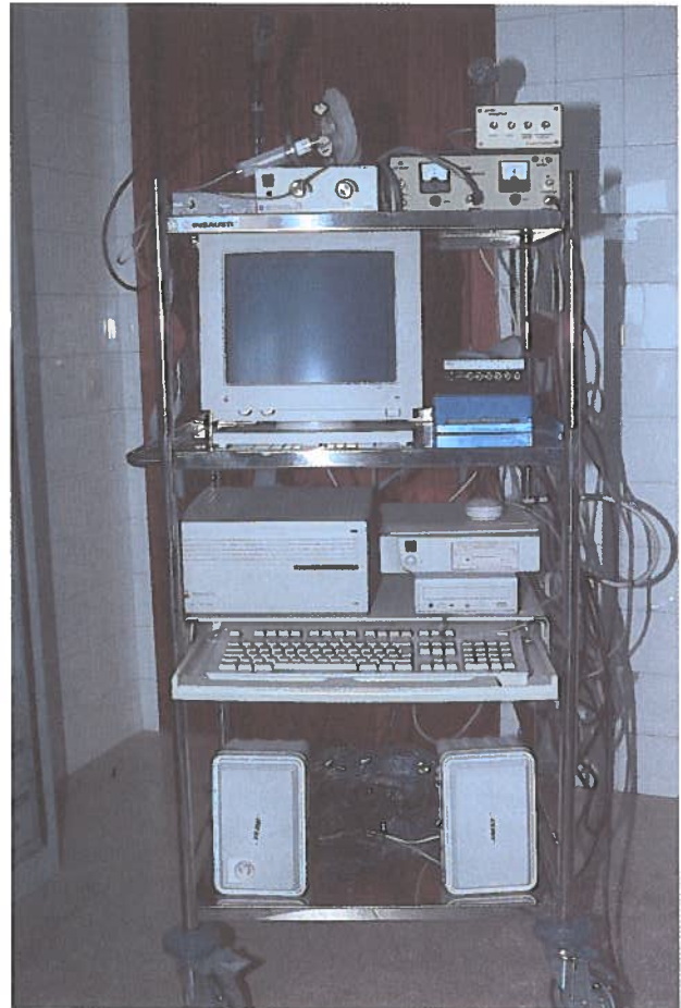
FIG. 3.—Equipo para análisis vocal basado en un ordenador Apple Macintosh y el programa SoundScope.
