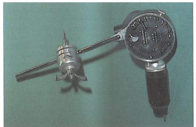
FIG. 8.—Esfera del stroboret de Tarneaud graduado en notas, frecuencias y octavas musicales. En este aparato se incorpora la lámpara en el interior de la caja.
